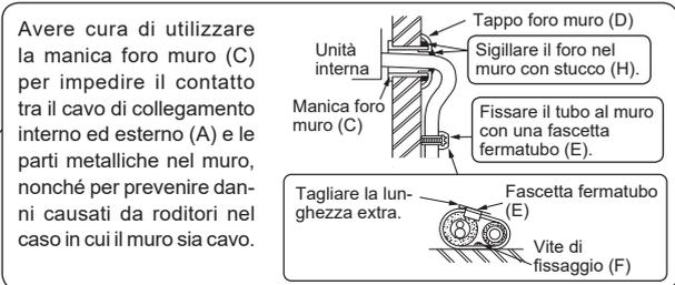
Avere cura di utilizzare la manica foro muro (C) per impedire il contatto tra il cavo di collegamento interno ed esterno (A) e le parti metalliche nel muro, nonché per prevenire danni causati da roditori nel caso in cui il muro sia cavo.
